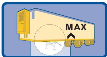
**Antes de embarcar, recoja al máximo las patas delanteras y traseras de su remolque.**
